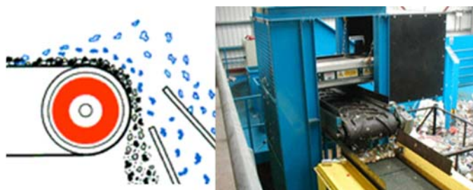
Figura 9 – Tecnologias de separação de metais não ferrosos – Corrente de Eddy .
