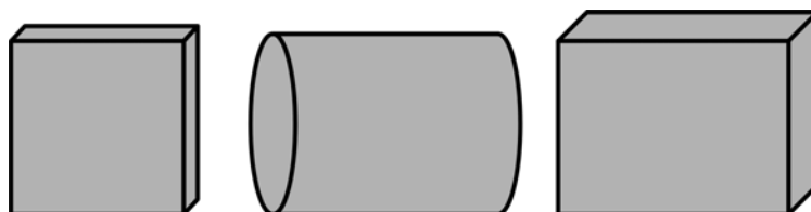
Figura 18 – Exemplificação dos diferentes tipos de embalagem e armazenagem do CDR. Fardos cúbicos (esquerda), Pilhas cilíndricas (ao centro) e Fardos paralelepípedicos (direita).
