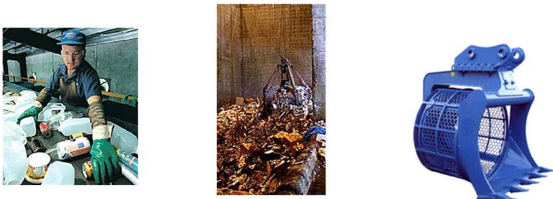
Figura 7 – Operações de triagem e separação mecânica – triagem manual, separação com garra e com balde.
